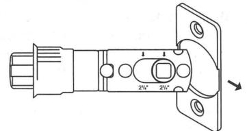
2C. Pour les poses de loquet encastré, tourner la tête de loquet de 20 degrés dans le sens horaire et retirer la tête de dos du loquet (aucune tête n'est nécessaire).
