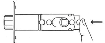
1D. Pour le régler à nouveau pour un écartement de 60 mm, pousser la came de tige vers le côté gauche du trou d'ajustement.
