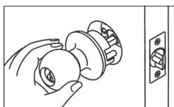
Avant de poursuivre, s'assurer que le trou de tige dans le loquet est orienté de façon appropriée.
