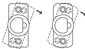
2B. S'il s'agit d'une tête de loquet pour mortaise à coins ronds, retirer la tête de loquet pour mortaise à coins carrés. Tourner la tête de loquet à coins carrés de 20 degrés dans le sens horaire et retirer la tête de dos du loquet. La remplacer par la tête de loquet pour mortaise à coins ronds.
