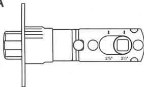
2A. S'il s'agit d'une tête de loquet pour mortaise à coins carrés, elle peut être utilisée comme telle (aucun ajustement n'est nécessaire).
